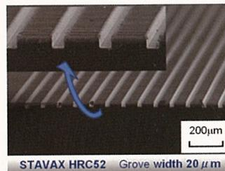
焼入れ鋼への超精密微細溝加工
